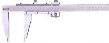
500 mm. Fabricado en acero carbono. Medidas en las bocas para medición interior. Tolerancia según DIN 862. Escala de pie de rey 0,05 mm.
