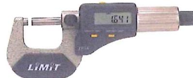
Digitales. Lectura 0,001 mm. IP 54. Lectura en mm o pulgadas. Apagado automático después de 5 minutos. Superficies de medición forjadas. Dedal de fricción y dispositivo de bloqueo. DIN 863.
